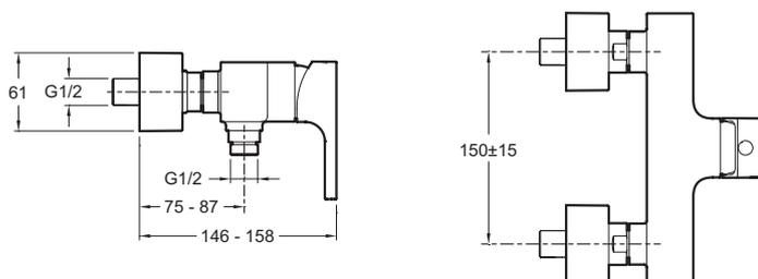
Descriptif CCTP : Mitigeur douche mural. E45371. Collection : STRAYT. POIDS : 3,7 kg. TYPE D'INSTALLATION : Mural. TYPE : Mitigeur. RACCORDS : Avec raccords et rosaces murales. MÉCANISME : Cartouche à disques céramique. Bague-limiteur de température. Clapet anti-retour sur sortie douche.
